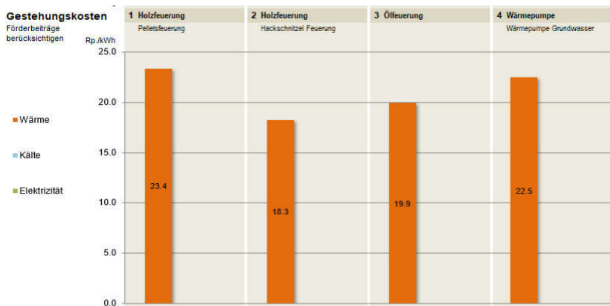
Abbildung: Diagramm Systemvergleich Heizungsanlagen, Stand 06.03.2023
